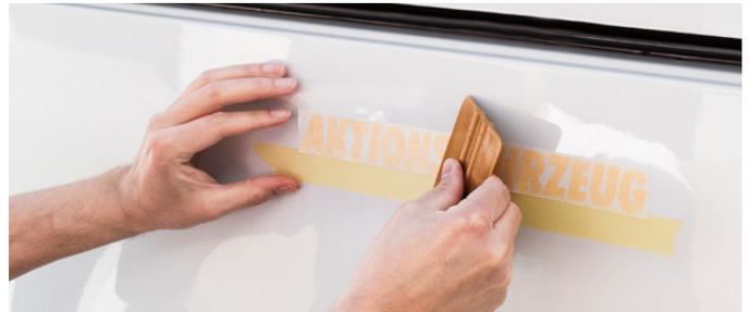
Richten Sie die Schriftzeilen an den gezogenen Hilfslinien (Krepp-Band) aus und fixieren Sie die Beschriftung leicht an der Fahrzeugoberfläche. Rakeln Sie nun die Schriftzeilen aus der Mitte heraus, in überlappenden Zügen an.
