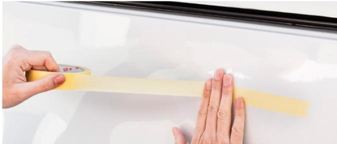
Ziehen Sie sich mit Krepp-Band Hilfslinien, an denen die Schriftzeilen ausgerichtet werden.
